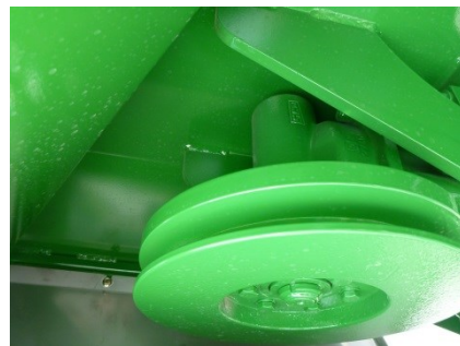
Messerbalkenantrieb abschmieren (5 Hübe der Fettpresse alle 50 Betriebsstunden)
