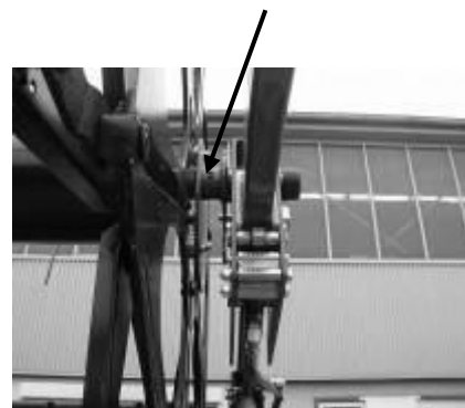
(Beide Seiten) Das Gehäuse der Haspelwelle abschmieren (5 Hübe der Fettpresse bzw. bis Schmierfett austritt)
