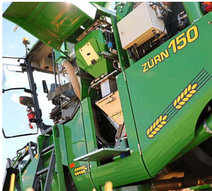
Herzstück Schleuse: Hier wird gewogen, analysiert und dokumentiert.
