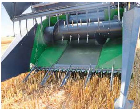
Reiner Tisch: Seitliche Luftdüsen pusten den Schneidwerkstisch sauber.
