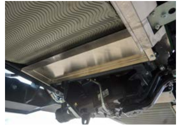
Wickelschutz für die Umlenkrollen am Messergetriebe.
