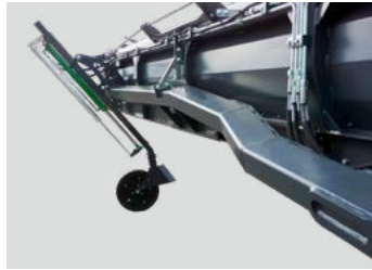
Verlängerter Auslegerarm und Überlastsicherung am Stützrad.
