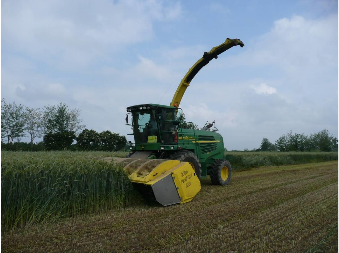
Profi Cut Direktschneidwerk im Einsatz
