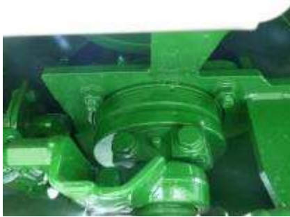
Lager des Messerkopfes schmieren
