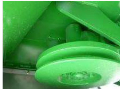
Messerbalkenantrieb abschmieren (5 Hübe der Fettpresse alle 50 Betriebsstunden)
