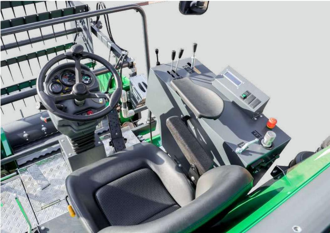
◀ Die Maschine ist sehr leicht zu bedienen und extrem service-freundlich. Der Fahrtrieb wird rein hydraulisch über ein Doppel-Fußpedal für Vorwärts- und Rückwärtsfahrt betätigt. Alle Schneidwerks- und Dreschwerks-Funktionen werden über die mechanische Ventilbetätigung direkt vom Fahrersitz gesteuert.
