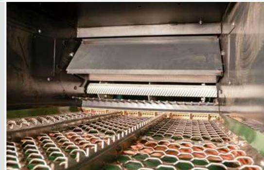
◀ Der kompakte Siebkasten mit nur einer Injektorschleuse ermöglicht einen deutlich verkürzten Radstand. Das erhöht die Wendigkeit im beengten Zuchtgarten.
