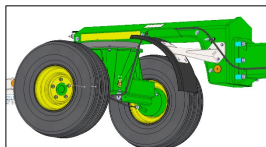
Nachstellschraube durch Drehen im Uhrzeigersinn anziehen.
