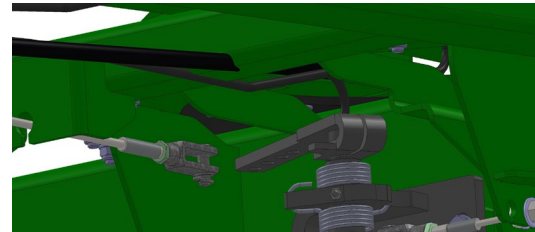
Bremszug während der Einstellung der Radbremsen aus dem Übersetzungshebel entfernen.
