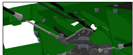
Vis de réglage du frein de roue A tourner dans le sens horaire.
