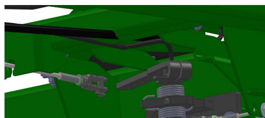
Pendant le réglage des freins, retirer les câbles de frein du levier de démultiplication
