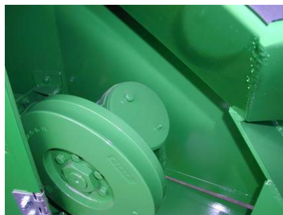
Смажьте привод ножевой траверсы (5 ходов смазочного шприца каждые 50 часов работы).
