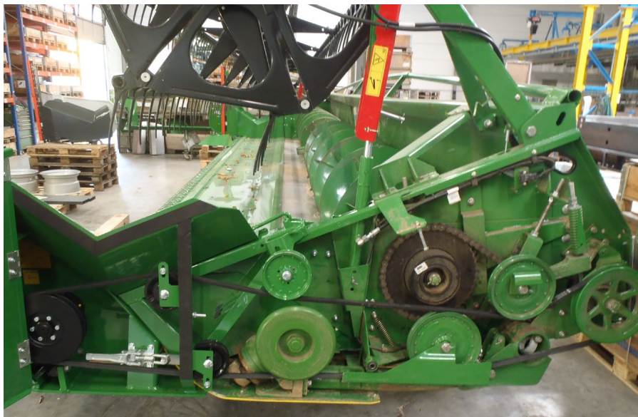
Abbildung zeigt die Riemenführung
