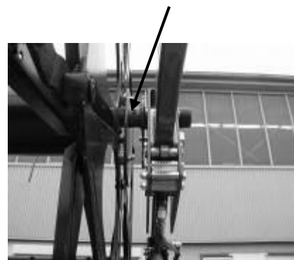
Graissez, de chaque côté, le palier des rabatteurs (5 courses de pompe à graisse ou jusqu'à ce que de la graisse s'échappe)
