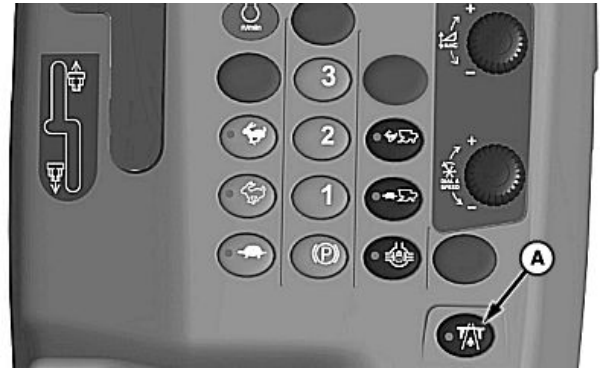
A—Interrupteur de sécurité route/champs
