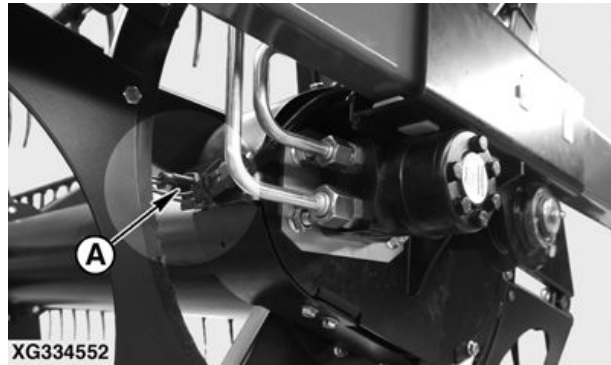
Capteur de vitesse du rabatteur (722PF—735PF)
