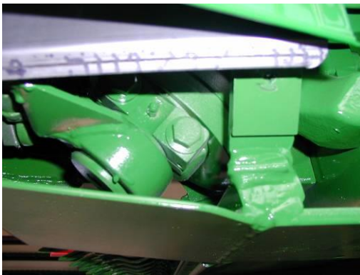
Lager des Messerkopfes schmieren
