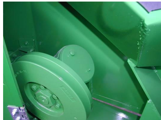
Messerbalkenantrieb abschmieren (5 Hübe der Fettpresse alle 50 Betriebsstunden)
