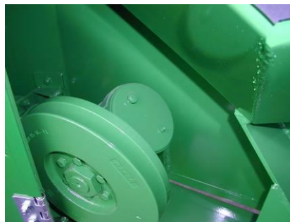
Messerbalkenantrieb abschmieren (5 Hübe der Fettpresse alle 50 Betriebstunden)
