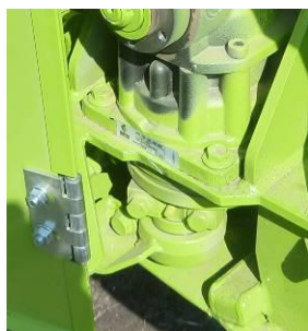
Смазывайте подшипники ножевой головки
