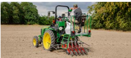
ZÜRN D62 Parzellen-Sämaschine mit Bandkopf
