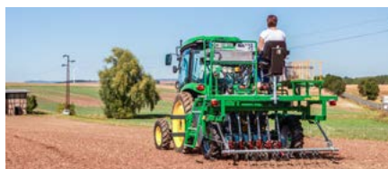
ZÜRN D92 Einzelreihen-Sämaschine mit Magazintisch
