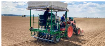
ZÜRN D82 Parzellen-Sämaschine mit Bandkopf
