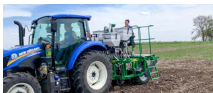
ZÜRN D82-AXL Parzellen-Sämaschine für Direktsaat
