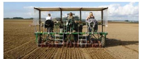
ZÜRN D82-3 Dreifach-Parzellensämaschine
