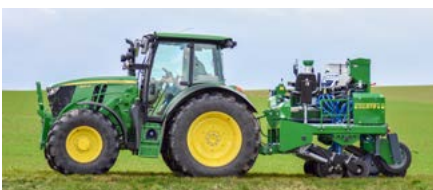
ZÜRN D72 Schwere Direktsaat-Parzellensämaschine
