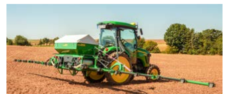
ZÜRN D55 Épandeur d'engrais pneumatique à trémie pour micro-parcelles
